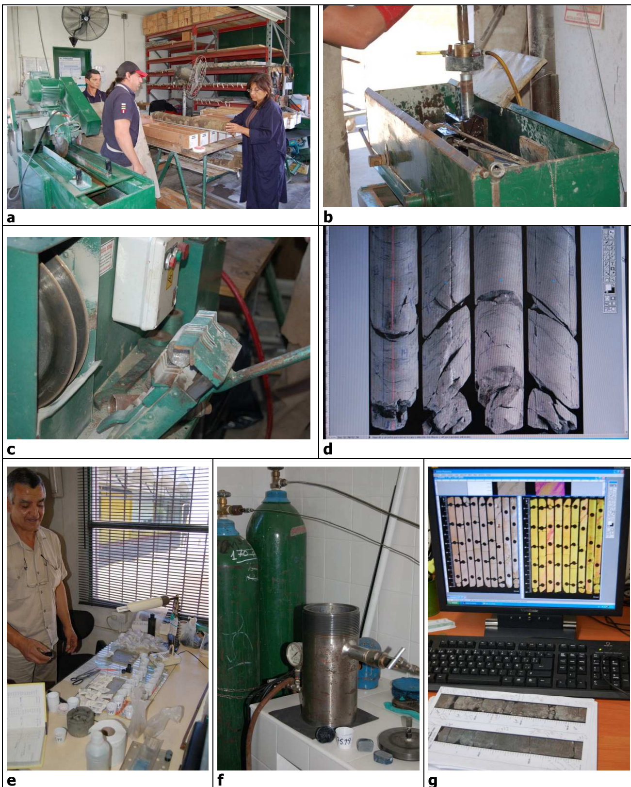
Figura 2 – Documentação fotográfica das atividades de preparação e controle de amostras para ensaios de petrofísica (a, b, c, d, g) e petrografia (e, f)
